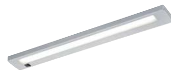
Unterbauleuchte · cabinet lighting ↔ 55 x 7 cm, ↓ 2 cm incl. SMD-LED, 7 W 600 lm, 3.000 K
